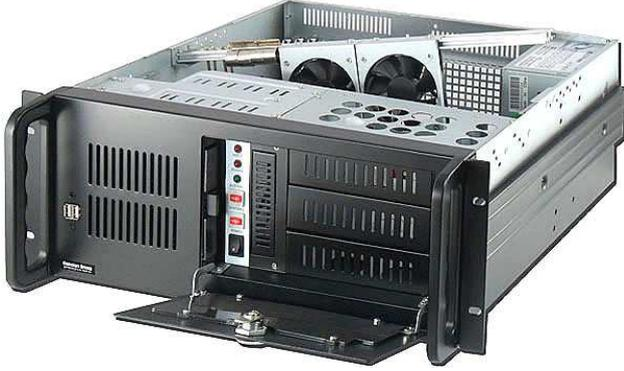
C480 最大的特色之一在於其鋁擠型介面卡壓條設計，其設計可上下前後左右調整風扇方向。此款設計採用 1.0mm 厚度 SGCC 超高強度無花鋼板，所有板金件之切斷面皆採平滑折邊設計以確保不割手。前方之安全把手亦採用超高強度之壓鑄材料製作而成，可確保機構強度堅固耐用。本機型除了可安裝一般標準之 12"x9.6" ATX 主機板之外，亦可安裝 eATX 的 12"x10.5" 伺服器專用主機板，適用於各種系統環境，此外在價格上也絕對具有競爭之優勢，歡迎全世界客戶經銷。
